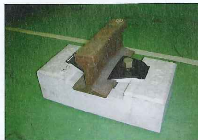
写真5 ■ 開発した枕木。電食でボルトが折れるのを防ぐため、レールの固定金具は絶縁性が高い「ナブラ型締結装置」を採用する(写真:横浜市交通局)
