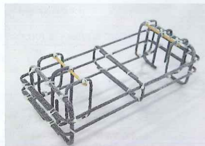
写真6 ■ 枕木に使う炭素繊維補強材を組み込んだもの。プラスチック製の結束バンドを利用している
